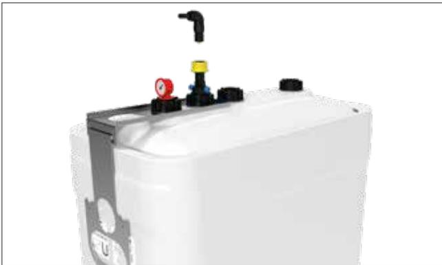
10. Den 90° Winkel und die Schlauchtülle verbinden und auf der Schnellkupplung montieren.
