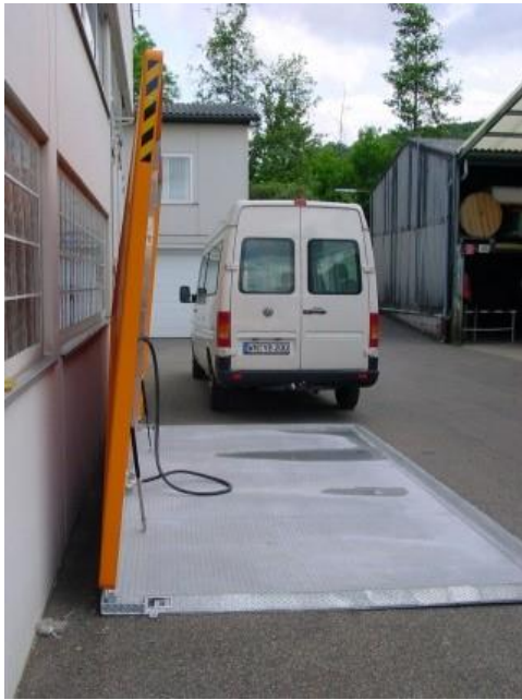
Abbildung 5: Korrekt eingestellte Neigung der Deckel
